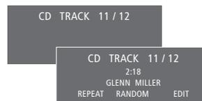
Die erweiterte Statusanzeige wird nicht immer angezeigt. Nur die erste Zeile ist dauernd sichtbar. Wenn Sie das Musiksystem bedienen, zeigt das Display für kurze Zeit zusätzliche Informationen wie Titeldauer und CD-Name an. Wenn Sie die Displayeinstellung in ERWEITERT ändern, zeigt das Display den aktuellen Status und zusätzliche Informationen dauerhaft an. Auf S. 15 finden Sie weitere Informationen.
