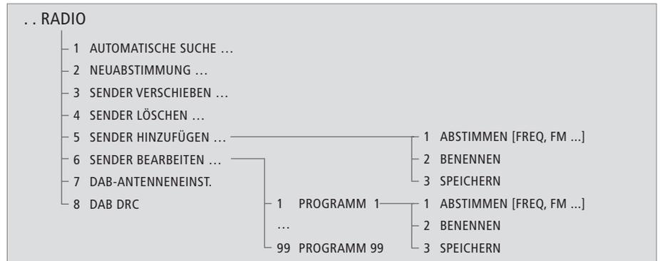
Um das RADIO-Menü zu öffnen, drücken Sie LIST, gehen in das SETUP-Menü und dann in das RADIO-Menü.
